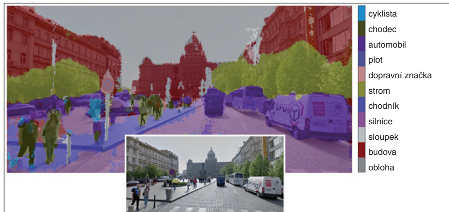
Obr. 2. Sémantická segmentace obrazu metodami typu deep learning
