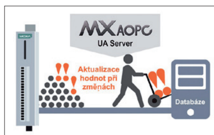
Obr. 3. Server AOPC umožňuje komunikaci podmíněnou změnami a událostmi a propagaci alarmů v reálném čase
