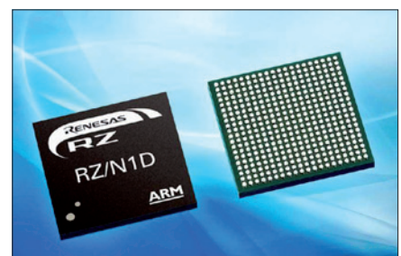
Obr. 8. Mikroprocesor RZ/N1D je vhodný pro jednotky master průmyslového Ethernetu (Renesas Electronics)
