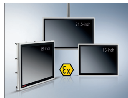
Obr. 3. Pro konstruktéry strojů a zařízení určených do prostředí s nebezpečím výbuchu jsou k dispozici dotykové panely s certifikátem ATEX vhodné do zón 2 a 22 s nebezpečím výbuchu
