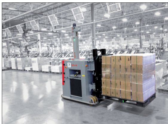
Obr. 1. Dopravní vozidlo bez řidiče spolehlivě nahradí vysokozdvížeňový vidlicový vozík (foto: Grenzebach Maschinenbau GmbH)
