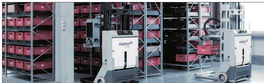
Obr. 2. Regálový zakladač bez řidiče umožňuje automaticky přistupovat ke zboží uloženému ve skladu (foto: Viastore Systems GmbH)
