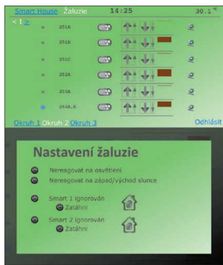
Obr. 5. Pro každou žaluzii je vidět její poloha vzhledem k oknu (horní obrazovka), každé žaluzii lze nastavit individuální podmínky funkce (dolní obrazovka)
