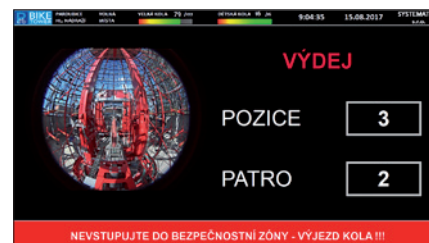
Obr. 2. Průvodce parkování – výdej kola (živý obraz kamery zakladače)
