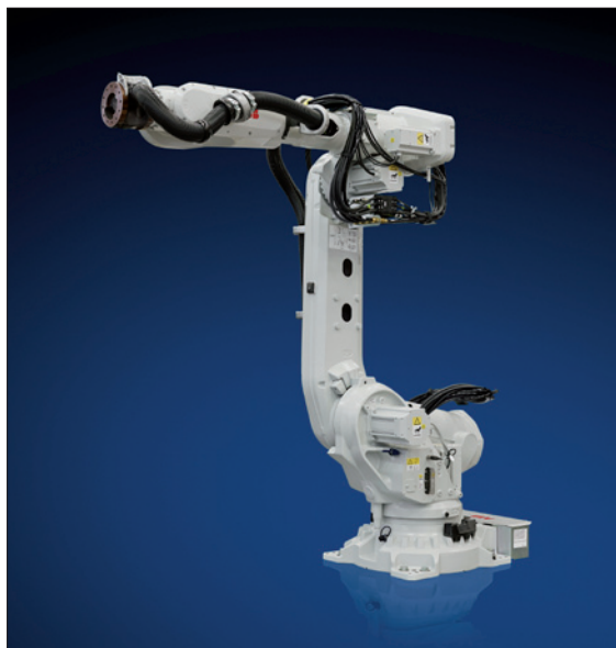
Obr. 4. Robot IRB 6700 s velkou nosností se často používá ve svařovacích buňkách
