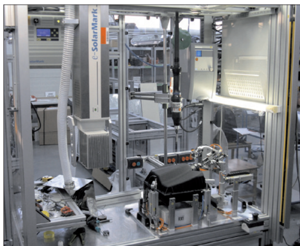
Obr. 2. Automat s nainstalovaným CO 2 laserem Solaris
