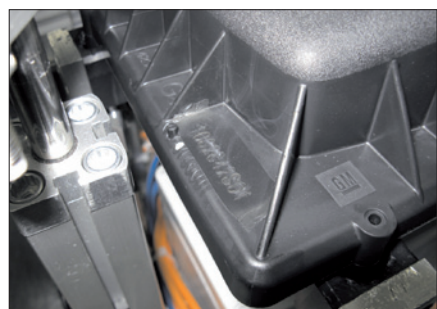
Obr. 1. Značení CO 2 laserem odolává povětrnostním vlivům a provozním kapalinám
