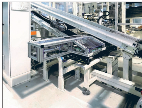
Obr. 4. Šikmý pásový dopravník pro přesun výrobků k finální montáži
