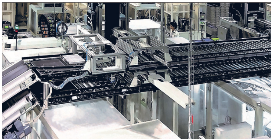
Obr. 1. Dopravníkové trasy s výtahy a točnami pro transport rozpracovaných výrobků v přepravních kazetách mezi stroji
