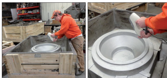
Obr. 3. Využití skeneru Artec Eva ke kontrole kvality odlitků ve společnosti Willman Industries
