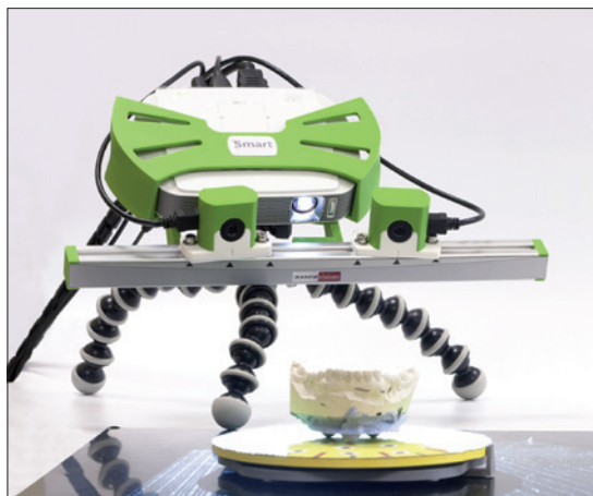
Obr. 2. Dvoukamerový stacionární skener RangeVision Smart s předmětem (odlitek zubů) na otočném stole
