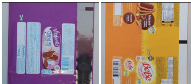
Obr. 4. Na jedné z linek se používají obaly, které mají čárové kódy na opačných stranách, a při změně sortimentu výroby je proto nutné přesunout také kameru
