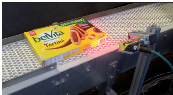
Obr. 1. Čárové kódy jsou kamerami Cognex snímány v různých stupních balicího procesu, před balením (nahore) i po zabalení (dole)
