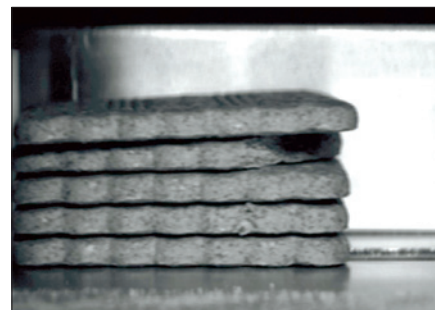
Obr. 2. Sušenky se skládají na sebe po čtyřech nebo po pěti; je-li některá z nich zlomená, je to kritická závada a balení je nutné vyřadit
