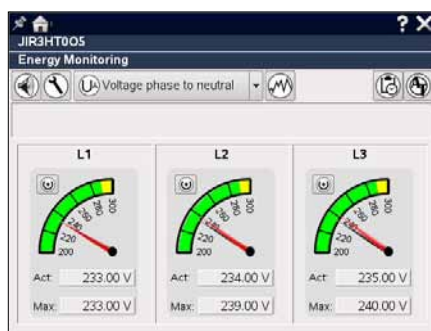
Obr. 3. Měření proudu, frekvence a jalové složky ve všech třech fázích s použitím modulu X20AP pomáhá zvyšovat spolehlivost dodávek elektřiny
