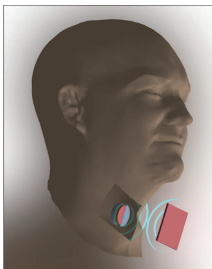
Obr. 1. Koncept bezkontaktního přenosu energie a dat mezi aktivním implantátem a okolím ultrazvukem (foto: Fraunhofer IBMT)
