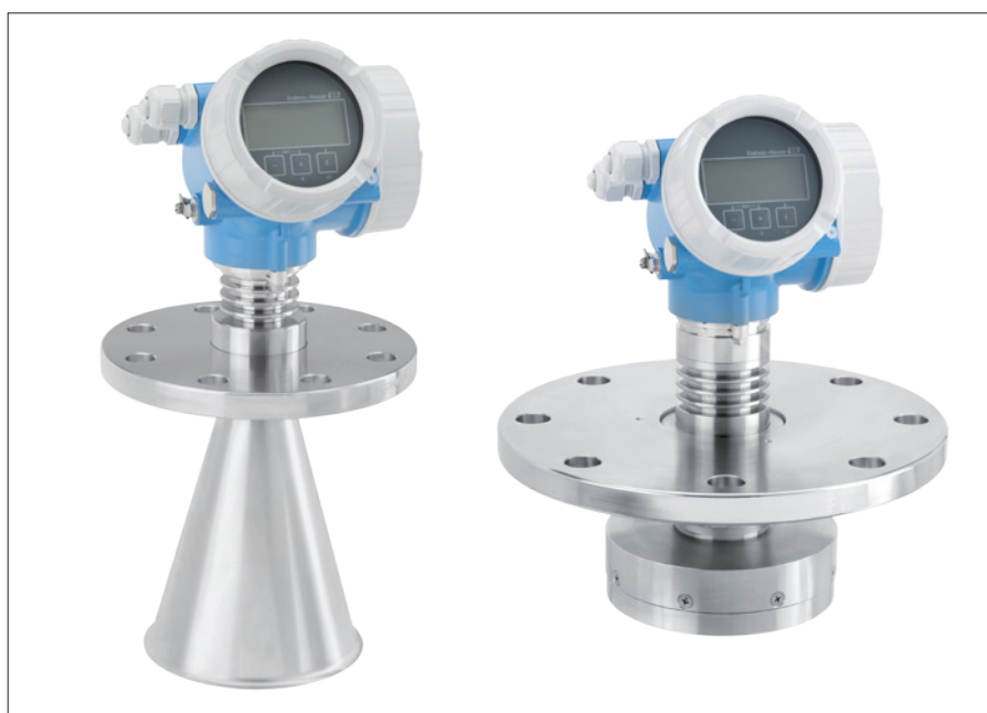
Obr. 5. Radarové hladinoměry Micropilot FMR54, vlevo s trychtýřovou anténou, vpravo s planární anténou, vhodné pro ukliďňovací trubky v nádržích, pracují na frekvenci 6 GHz
