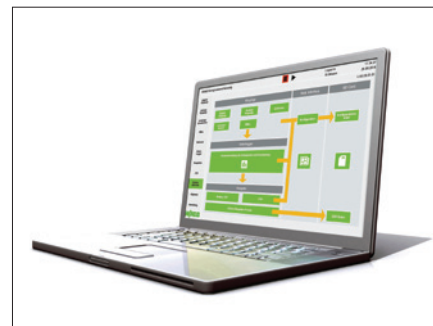
Obr. 2. Kromě energetických hodnot lze pomocí nového řešení Wago Energy Data Management zaznamenávat i mnoho dalších měřených veličin: např. parametry elektrického proudu, plynu, tepla, vody, stlačeného vzduchu a teploty; vše pro sběr a zpracování dat se nastavuje ve webovém grafickém rozhraní – zcela bez programování
