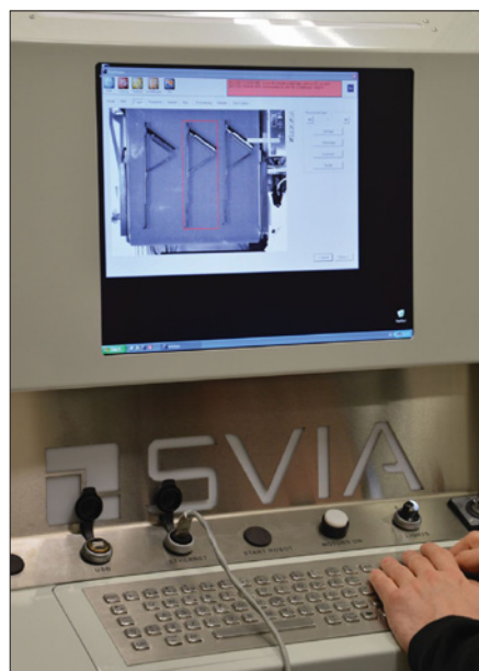
Obr. 1. Software Pickvision od společnosti SVIA je určen pro robotické odebírání součástek z pásu
