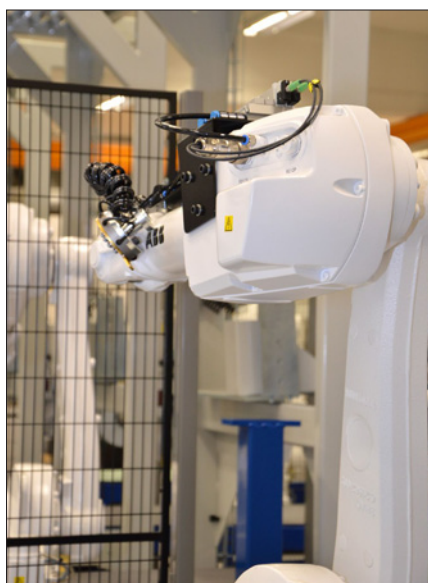
Obr. 2. Společnost SVIA nejčastěji používá roboty ABB; ty mají zpravidla rozhraní pro DeviceNet
