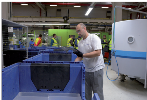
Obr.1. Operace pokovení plastových komponent
