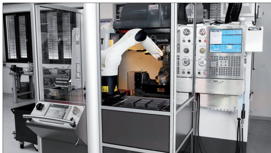
Obr. 1. Malý robot Kuka KR Agilus v robotické buňce MRC flextray zajišťuje ve společnosti Dannoritzer Medizintechnik flexibilitu při vkládání obrobků do obráběcích center a jejich vyjímání
