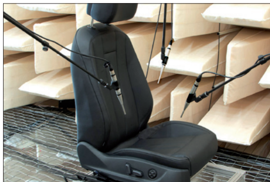
Obr. 1. Metodu automatizované analýzy kvality na bázi akustického měření nabízí Fraunhoferův ústav IDMT např. pro ověřování motorů nastavujících polohu komponent autosedaček (foto: Fraunhofer IDMT)
