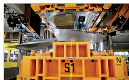
Obr. 4. Manipulátor Crossbar Feeder vytahuje výlisek z formy a bez mezistanice jej přesouvá do dalšího stupně lisovací linky
