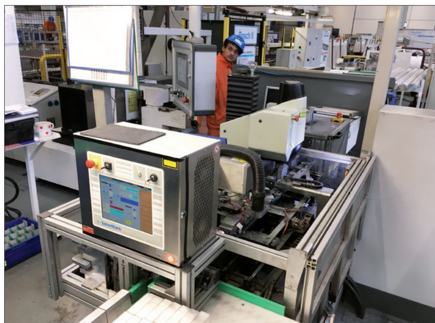
Obr. 2. Laserové pracoviště s laserem Solaris e-SolarMark FL10 a dotykovou ovládací jednotkou CU2
