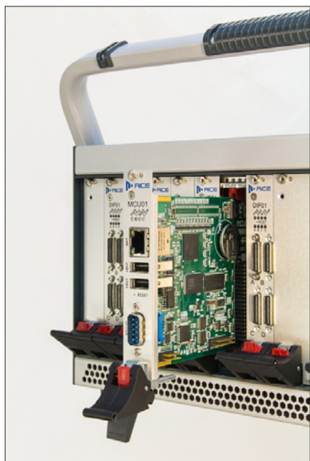
Obr. 4. Modulární řídicí systém REMCS (RICE)
