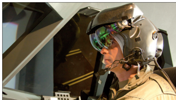
Obr. 2. Zkušební pilot při zkouškách náhlavního displeje na letovém simulátoru (foto: DLR)
