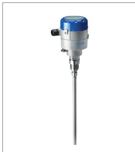
Obr. 1. Hladinoměr Optiflex 1100 C s koaxiálním vlnovodem pro kapaliny s malou permitivitou
