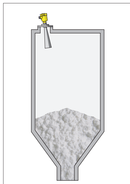
Obr. 3. Měření zaplnění sil s popílkem radarovým hladinoměrem Vegapuls 68
