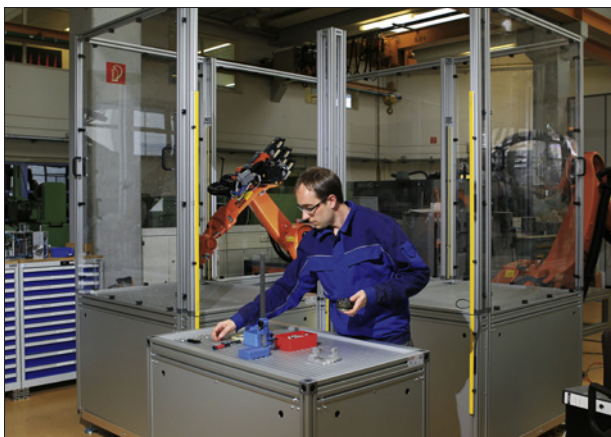
Obr. 3. Robotický systém Silia efektivně a naprosto bezpečně spolupracuje s dělníkem na společném pracovišti (foto: Fraunhofer IPA)
