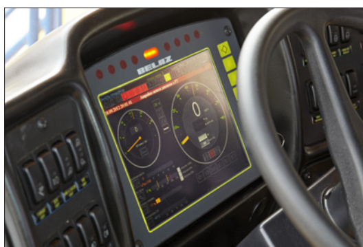
Obr. 2. Panel B&R MA730 v kabině řidiče přehledně zobrazuje všechny provozní údaje vozidla
