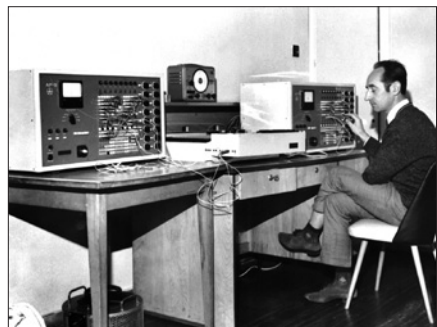
Obr. 1. Autor článku, Vladimír Strakoš, pracuje s prvními analogovými počítači v provedení pro cvičení studentů; uprostřed je vidět souřadnicový zapisovač pro kreslení výsledků simulace (kolem roku 1972)
