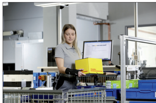
Obr. 3. Paexo Wrist pomáhá pracovníkům, kteří zvedají těžká břemena, a současně chrání citlivou oblast zápěstí před zraněním
