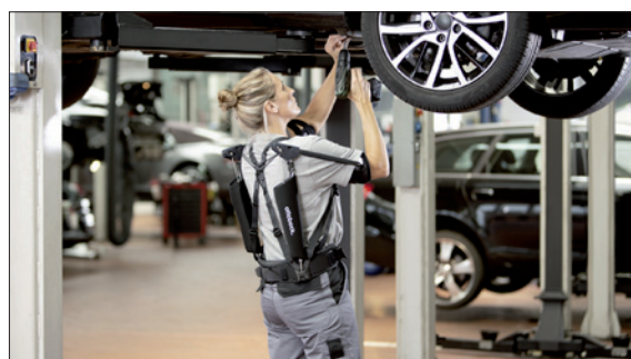
Obr. 1. Exoskeleton Paexo Shoulder ulevuje svalům a kloubům v oblasti ramene, zvláště při práci nad hlavou
