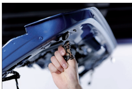
Obr. 2. Nejmenší exoskeleton na světě, Paexo Thumb, rozvádí síly z palce na celou ruku
