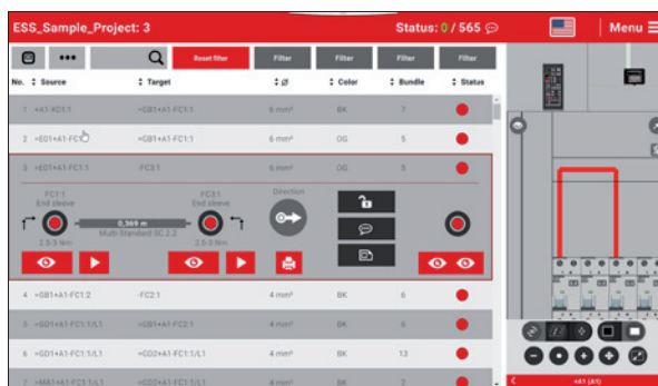
Obr. 2. EPLAN Smart Wiring ve verzi 2.8 poskytuje uživatěm podporu při grafickém výběru komponent pro zapojení rozváděčů
