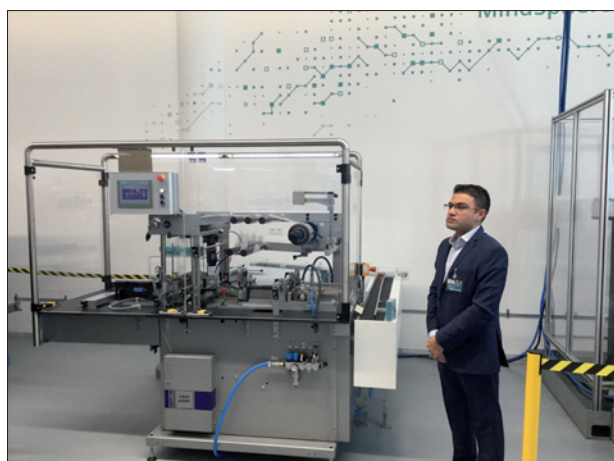
Obr. 2. Představení balicího stroje od firmy Sollas Machines, pro nějž je v pražském aplikačním centru vyvíjena elektronická vačka na procesoru Simatic S7-1500T (foto: autor)
