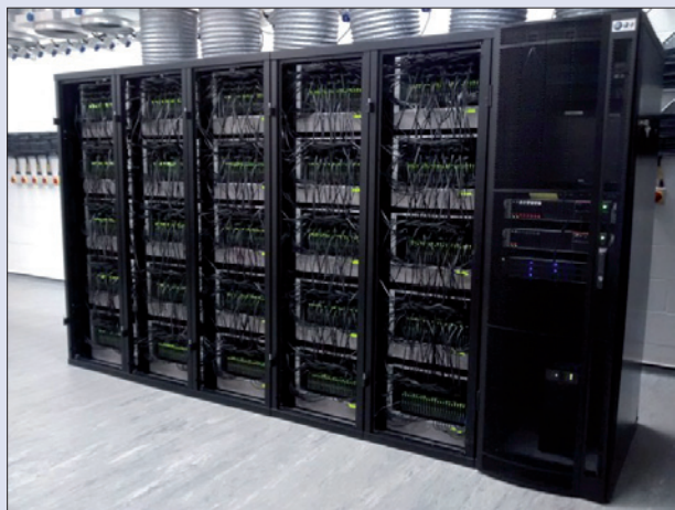
Obr. 32. Počítač Spinnaker s milionem počítačových jader simuluje činnost neuronů v mozku
