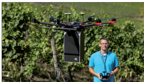
Obr. 1. Předváděcí model zařízení při jednom z prvních letových pokusů: podvěšený laserový systém pro letové použití musí být mj. kompaktní a lehký (foto: DLR)
