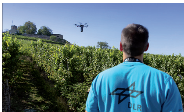
Obr. 2. Dron s laserovým systémem pro detekci škodlivých hub v letové akci nad vinicí (foto: DLR)
