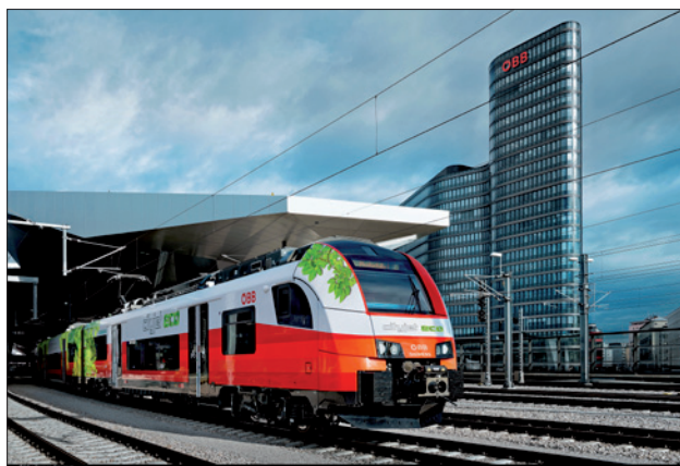
Obr. 1. Elektrická jednotka Cityjet eco může být napájena z trakčního vedení i z akumulátorových baterií
