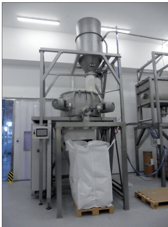
Obr. 2. Zařízení pro vysokorychlostní míchání zastudena
